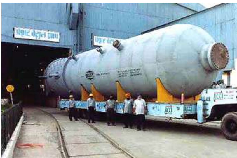
Рис. 2.24 — 130-тонний реактор гідроочистки дизельного палива, виготовлений фірмою ISGEC для заводу Indian Oil в Гуджараті
