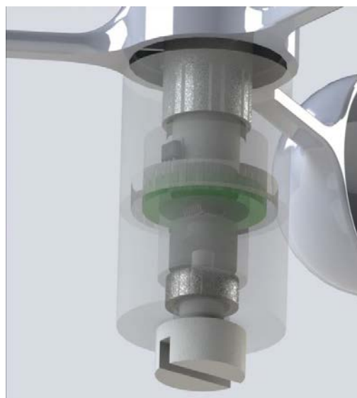
Рис. 5 – Спроектированная конструкция комбинированного датчика ветра
