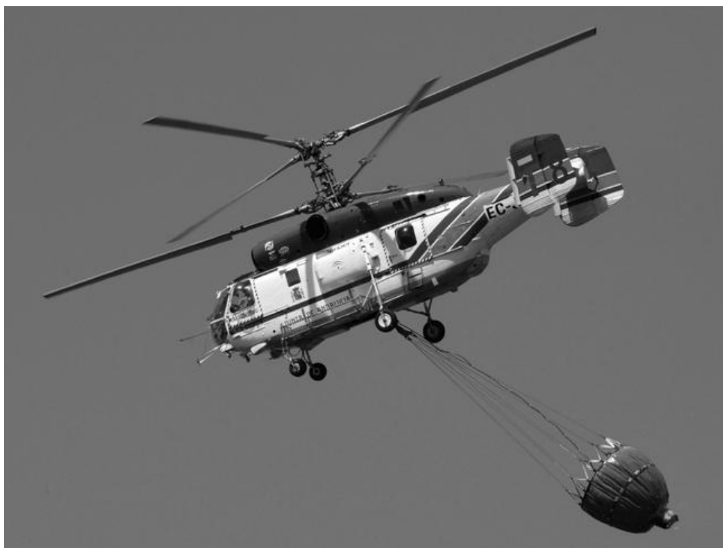
Рисунок 8.7 – Вертоліт Ка-32А11ВС з водозливним пристроєм
