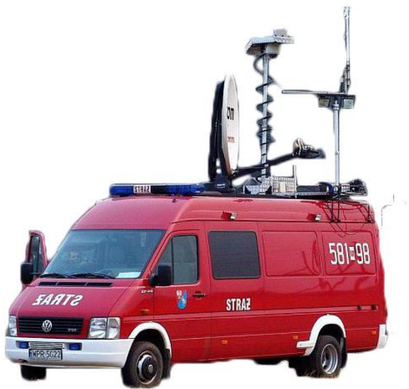
Рисунок 6.37 – Польський автомобіль управління і зв'язку на шасі Volkswagen LT 46
