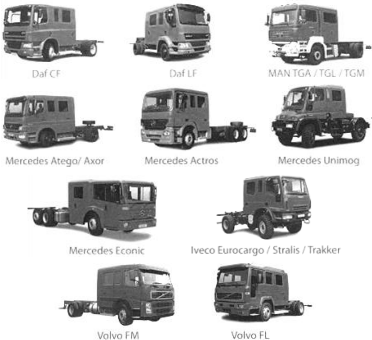
Рисунок 3.11 – Шасі різних виробників із пластмасовою кабіною
