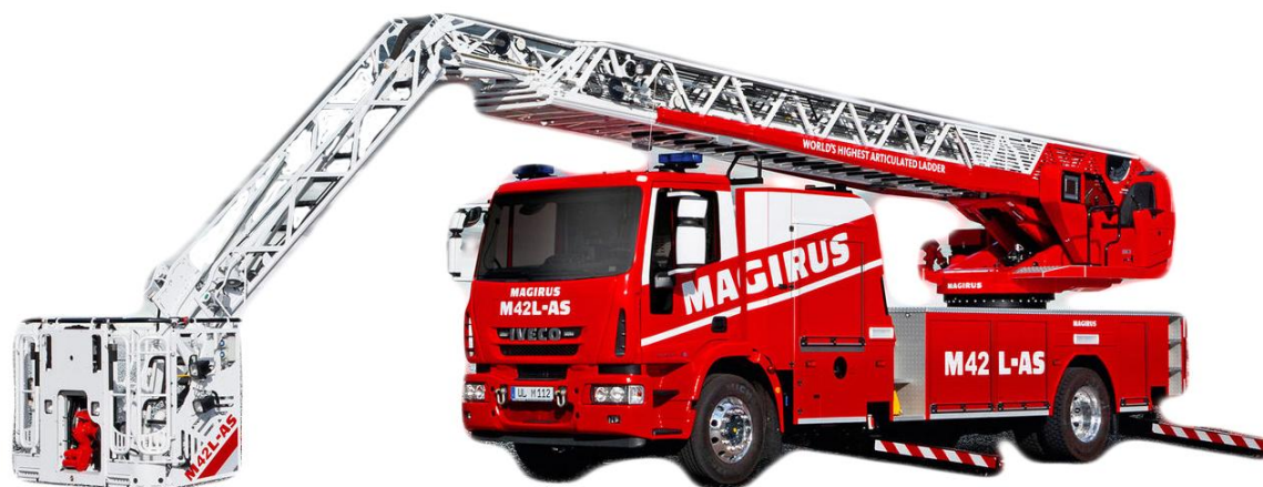
Рисунок 6.17 – Автодрабина MAGIRUS M42L-AS з люлькою та зчленованим коліном на базі автомобіля IVECO M42L-AS
