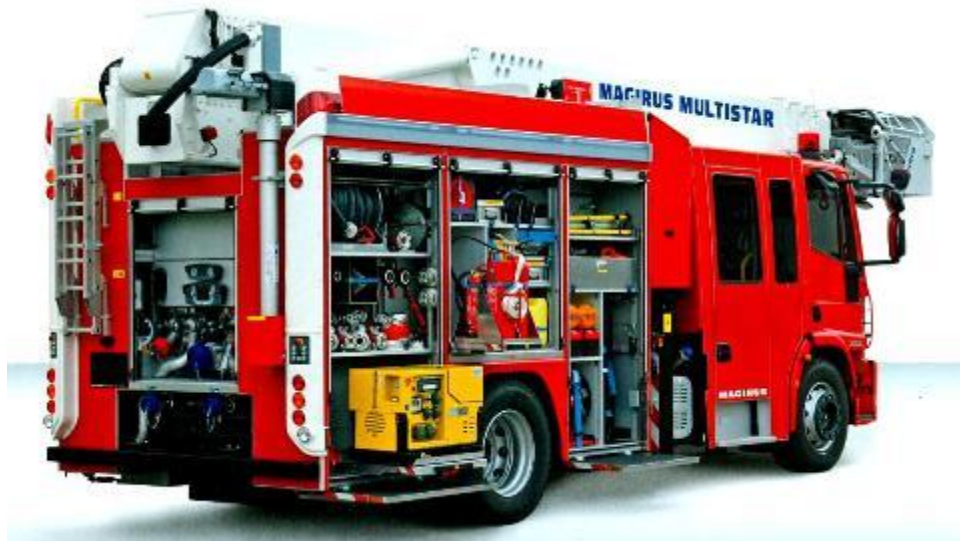
Рисунок 6.23 – Мультифункціональний пожежний висотно-рятувальний автомобіль Multistar-2
