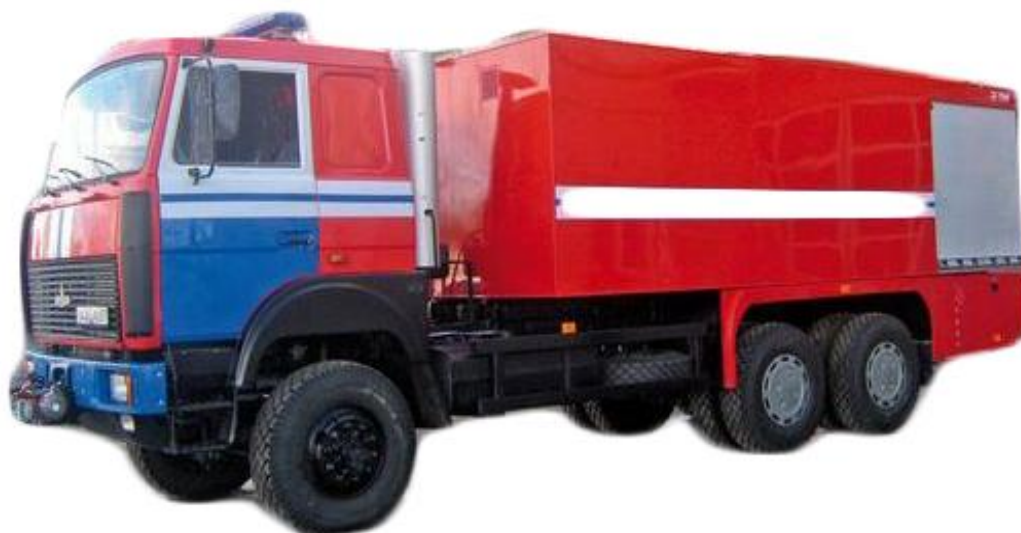
Рисунок 5.56 – Пожежна насосно-рукавна станція із запасом піноутворювача
