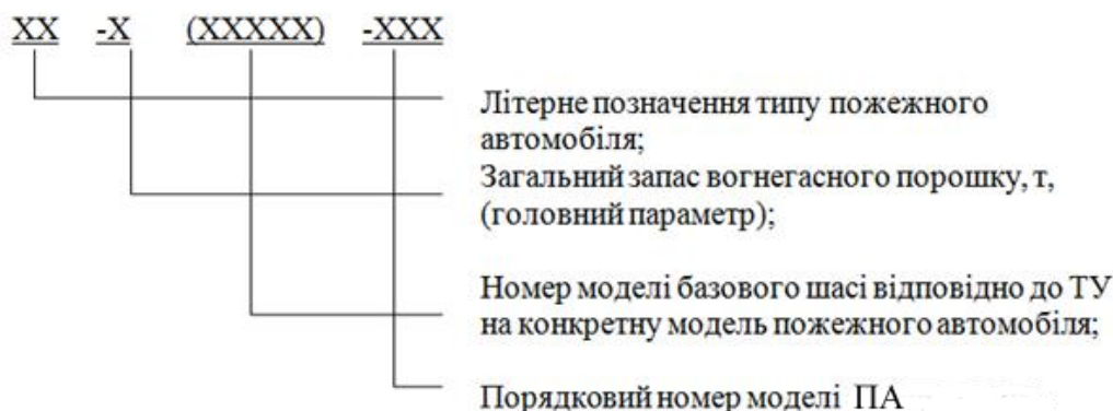
Рисунок 3.2 – Структурна схема позначення пожежних автомобілів типу АП залежно від головного параметра і базового шасі.
