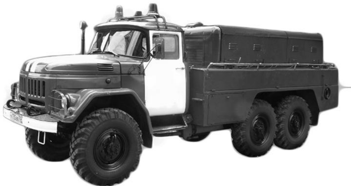
Рисунок 5.53 – Пожежна автонасосна станція ПНС-110 (131) 131А
