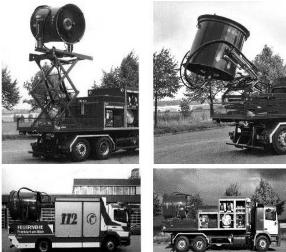
Рисунок 6.30 – Автомобіль димовидалення з вентилятором MGV фірми «BIG», які мають підйомний пристрій трапецієподібного типу
