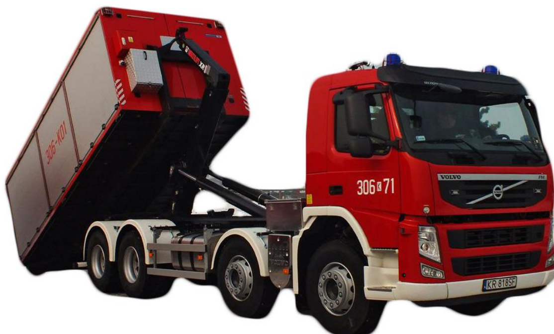
Рисунок 6.35 – Загальний вигляд САРМ контейнерного типу
