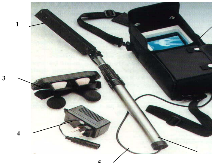
Рис. 3.1-Система відеопошуку Olympus 1 - відеокамера; 2 - монітор; 3 - стере окуляри; 4 - блок живлення; 5 - кабель; 6 - штанга
