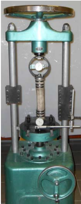
Рисунок 1 – Дослідна машина ДМ-30М із встановленим зразком рукава
