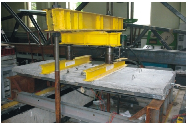
Рис. 2. Експериментальна установка для випробування плит
