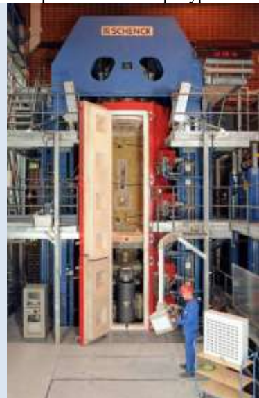
Рисунок 24 – Піч для випробування колон
