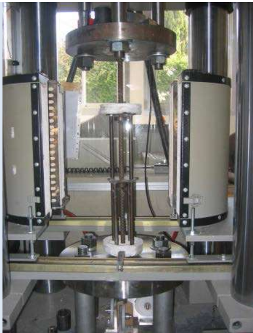
Рисунок 12 – Термомеханічна випробувальна система для арматурної сталі
