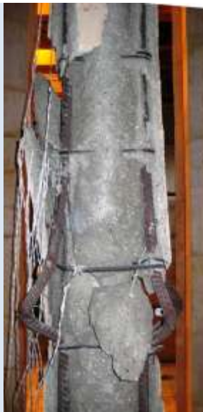
Рисунок 25 – Колона після випробування на вогнестійкість
