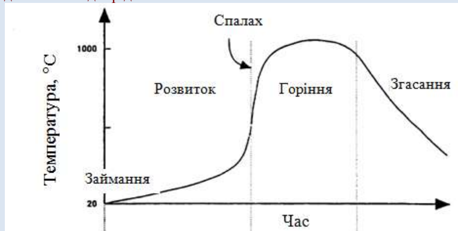
Рисунок 4 – Розвиток пожежі в будівлі
