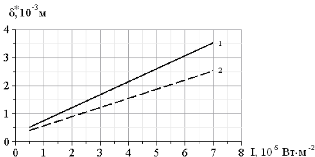
Рис. 2. Графік залежності товщини необхідного шару води \delta^* від інтенсивності горіння I і виду горючого матеріалу: 1 – чгарник; 2 – трава
