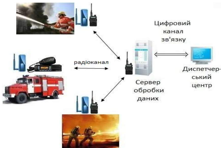
Рис. 1 – Передача даних GPS-трекерів по радіоканалам управління
