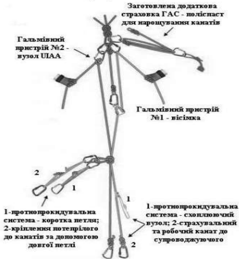
Рису. 1 – Кріплення потерпілого та супроводжуючого до спускових канатів та приклади організації протипрокидувальних систем
