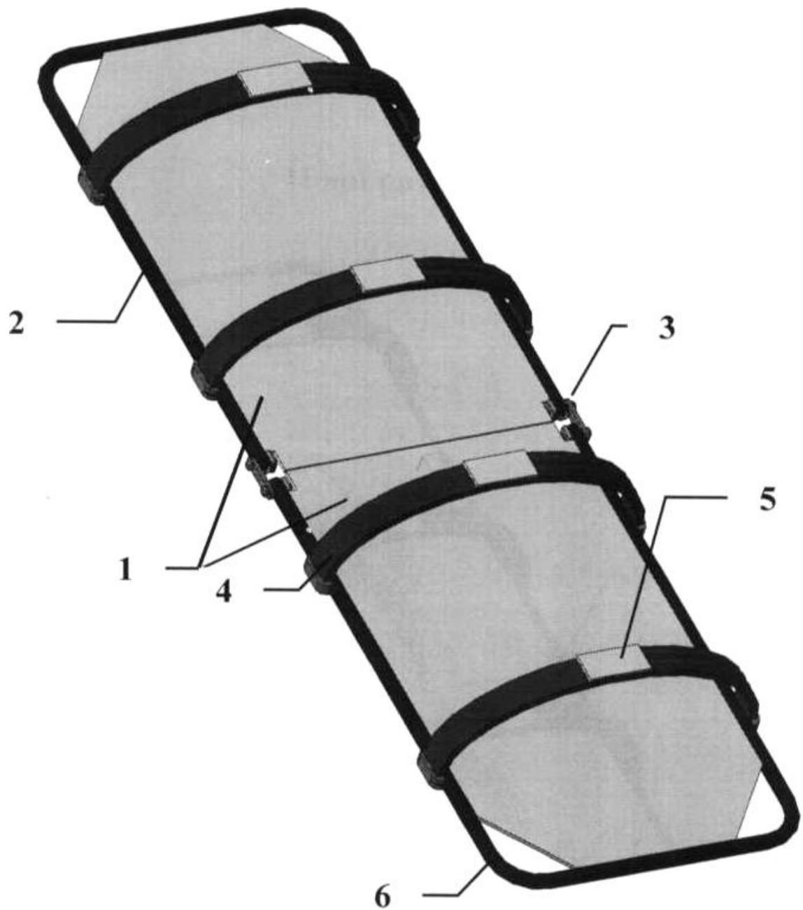
Корисна модель належить до спеціального оснащення, а саме - пристрій рятування постраждалих з місця виникнення надзвичайної ситуації, і може бути використана для евакуації постраждалих як з приміщень, так і під час проведення рятувальних робіт на відкритому просторі.
