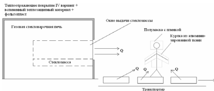
Рис. 6.12. Теплозащита рабочих мест при выдаче и формировании изделий из стекломассы
