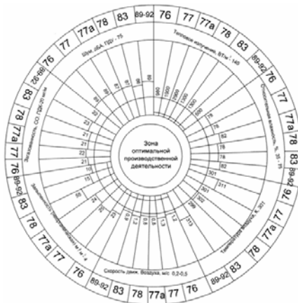
Рис. 6.20. Диаграмма условий труда рабочих мест (76, 77, 77а, 78, 83, 89-92) термического участка ООО «Сантехника ЗАЗ»: 76, 77, 77а – отпуск деталей; 78 – закалка деталей; 83 – извлечение деталей при открытой крышке с вынутой ретортой; 89-92 – отпуск деталей в вакууме
