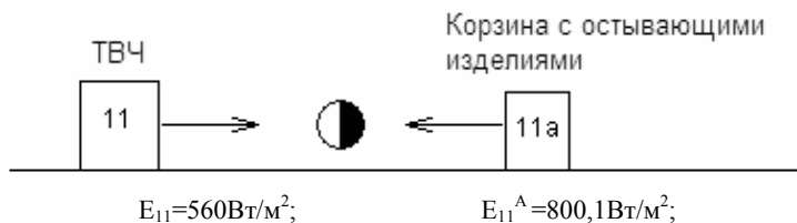
Рис. 5.4 Влияние высоких температур на рабочее место оператора от двух источников (источники 11 и 11а)
