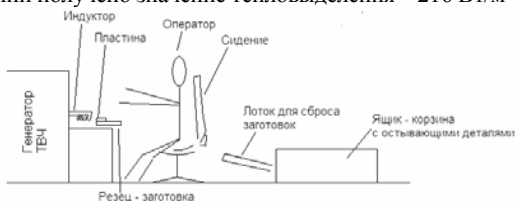
Рис. 5.1. Воздействие высоких температур на рабочее место оператора от установки ТВЧ (источник 11) при технологической операции – пайке
