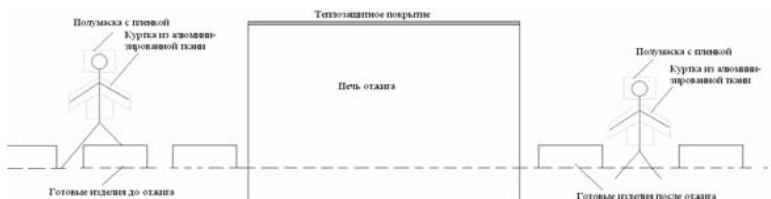
Рис. 6.13. Теплозащита рабочих мест у обжиговой печи
