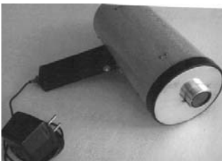
Рис. 4.10. Прибор для измерения лучистой составляющей теплового потока
