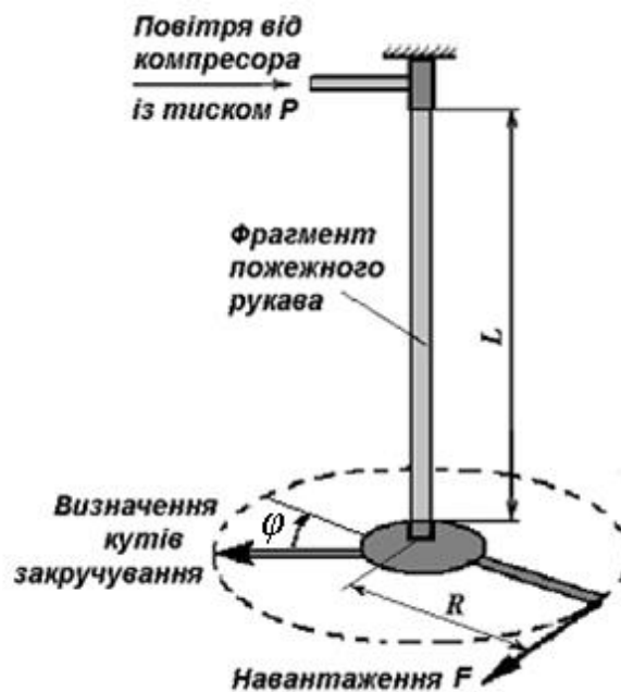
Рис. 1 – Дослідна установка із встановленим фрагментом пожежного рукава
