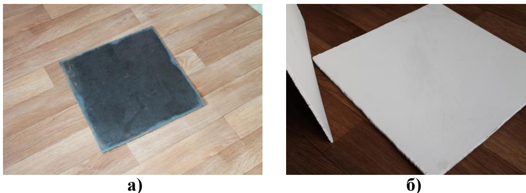
Рис. 2. Вигляд сталевих зразків: а – до нанесення вогнезахисної речовини; б – після нанесення вогнезахисної речовини
