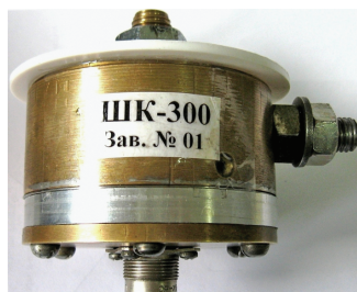
Рис. 1. Внешний вид измерительного коаксиального шунта ШК-300М, предназначенного для измерения затухающих синусоидальных и апериодических импульсов тока искусственной молнии амплитудой \pm 220 кА в разрядной цепи мощного высоковольтного генератора.
