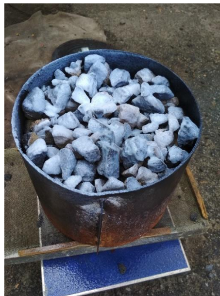
Рисунок 3 – Внешний вид модельного очага пожара класса В при толщине слоя ПС 12 см (фракция 2,5–4 см) с нанесенным слоем геля
