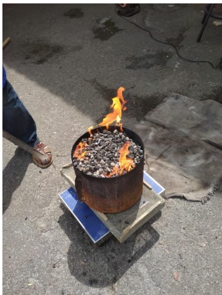
Рисунок 2 – Горение модельного очага пожара класса В при толщине слоя ПС (фракция 1–1,5 см) 14 см
