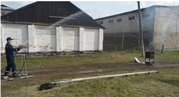
Рис. 5. Процесс дистанционного тушения водой модельного очага 1А из двух стволов-распылителей, где в течении отрезка времени около 25с было израсходовано 9,2 литров воды (каждым по 4,6л)
