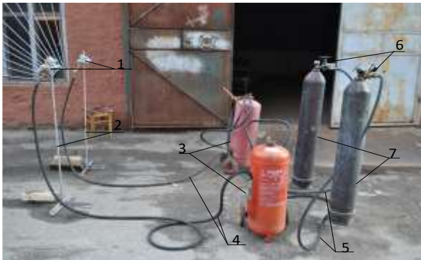
Рис. 2. Элементы опытной установки для дистанционной подачи бинарного потока ГОС на пожаротушение: 1. – два ствола-распылителя; 2. - штативы; 3. - емкости с водными растворами гелеобразующих составов (ГУС) 4. - шланги для подачи ГУС; 5. - шланги для подачи воздуха; 6. - редуктор с манометрами; 7. - баллоны со сжатым воздухом;
