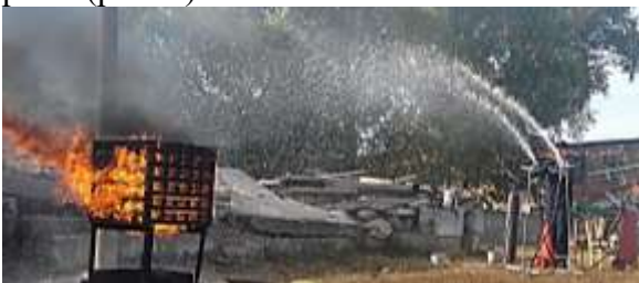
Рис. 6. Дистанционное тушение модельного очага 1А с использованием ГОС, компоненты которого подавались из тех же двух стволов-распылителей, в течении 13с, где было израсходовано около 6,0 литров ГОС
