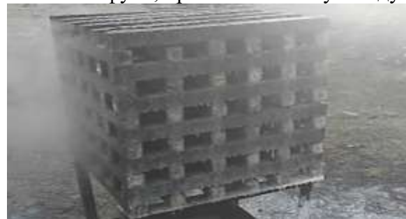
Рис. 7. Потушенный дистанционно модельный очаг с использованием ГОС
