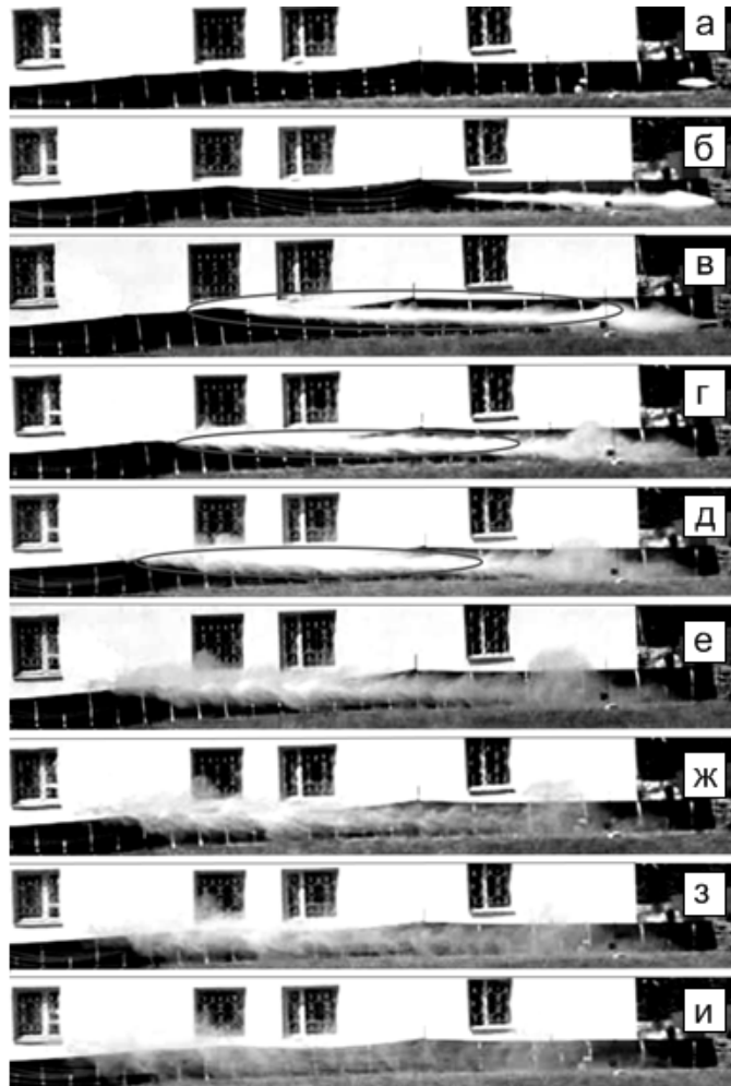
Рисунок 2 – Видеограмма распространения высокоскоростной водяной струи при массе порохового заряда m_p = 5 г
