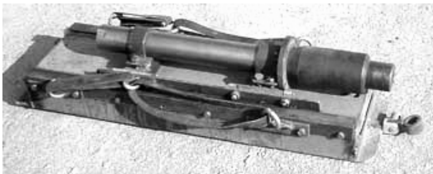
Рисунок 1 – Экспериментальный образец водяной системы пожаротушения импульсного действия
