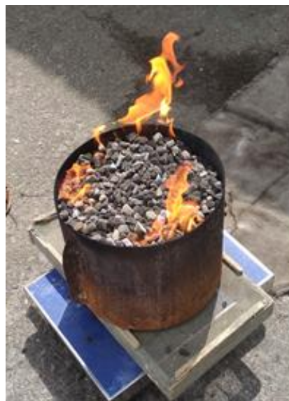
Рисунок 2 – Внешний вид стандартного модельного очага пожара класса 2В при толщине слоя пеностекла 14 см
