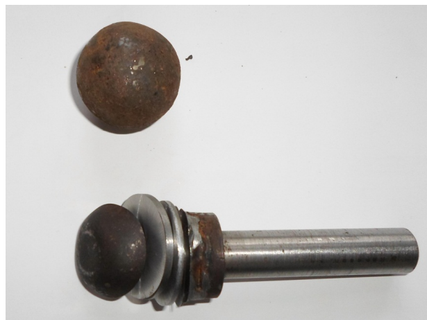
Рис. 2. Внешний вид целого шарика и полученных шайб
