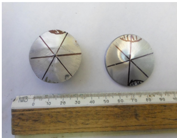
Рис. 3. Шайбы с отмеченными линиями, по которым измеряли твердость и сегментами, где твердость понижена
