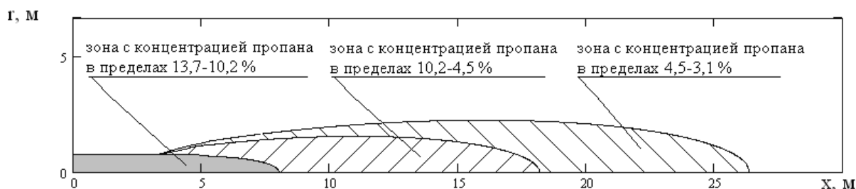
Рис. 1.18. Розподіл масової концентрації пропану в повітряному струмені при виході пропану з сопла з концентрацією 13,7 % у поперечному перетині: r – поперечна координата; x – подовжня координата.
