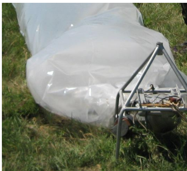
Рис. 3.4. Процес наповнення заряду з суміші вибухонебезпечних газів
