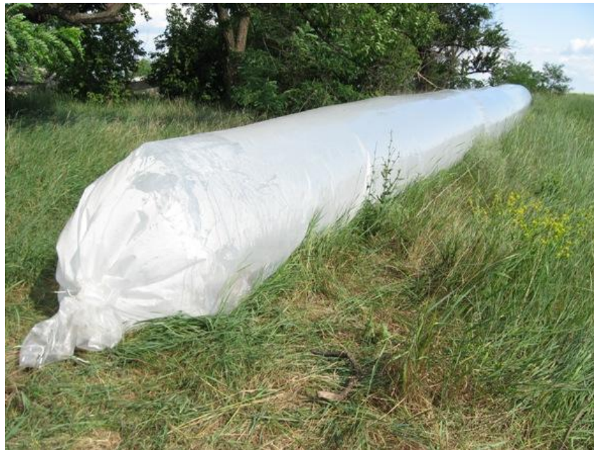
Рис. 3.1. Розташування заряду з суміші вибухонебезпечних газів на місці проведення експериментальних досліджень
