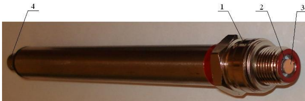
Рис. 3.7. Зовнішній вигляд п'єзодатчика тиску: 1 – корпус; 2 – п'єзоелемент; 3 – захисний шар; 4 – електричний роз'єм
