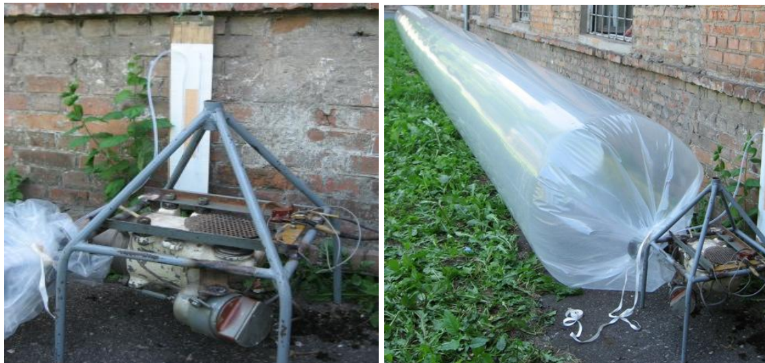
Рис. 3.6. Дослідження граничного надлишкового тиску, ведучого до руйнування оболонки заряду з суміші вибухонебезпечних газів
